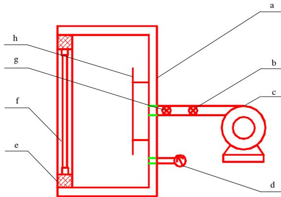
a—压力箱；b—调压系统，c—供压设备；d—压力监测仪器；e—镶嵌框；
